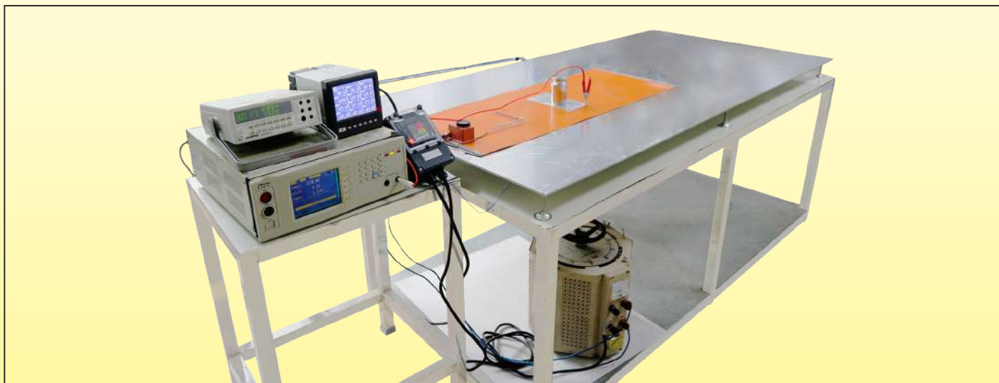
Apparecchiatura di misurazione per la dispersione di corrente totale a caldo
